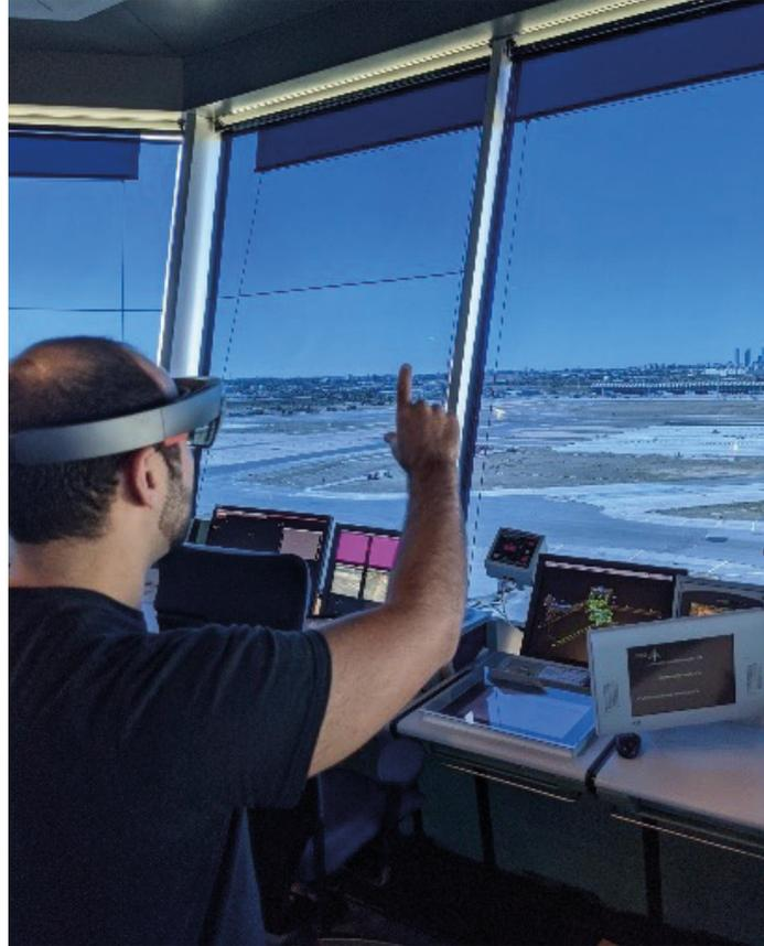
Gafas de realidad aumentada usadas para mostrar información adicional al controlador en la posición de control de torre.
